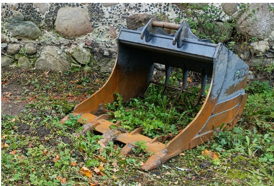
2.2. attēls. Straujteču atjaunošanā izmantojamais kaus ar 20 x 20 cm spraugām, lai samazinātu grants un oļu izņemšanu kopā ar ūdensaugu sakņu “velēnu”, Kaspars Abersona foto
